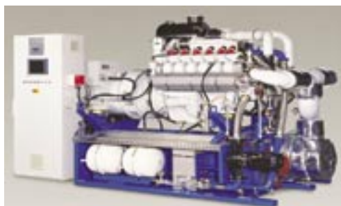
Figura 5- Tipico gruppo di cogenerazione costituito da motore a ciclo Otto, alternatore e sezioni recupero del calore dalle camicie del motore e dai gas di scarico
